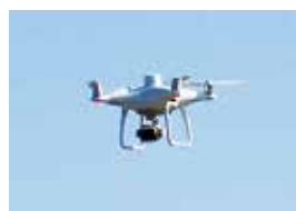
写真2 マルチスペクトルカメラ (赤外線等の波長の異なる6つのレンズ付き) 搭載ドローンの空撮状況
